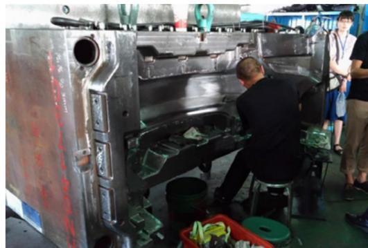
▲ 圖一、模具修補作業示意圖
