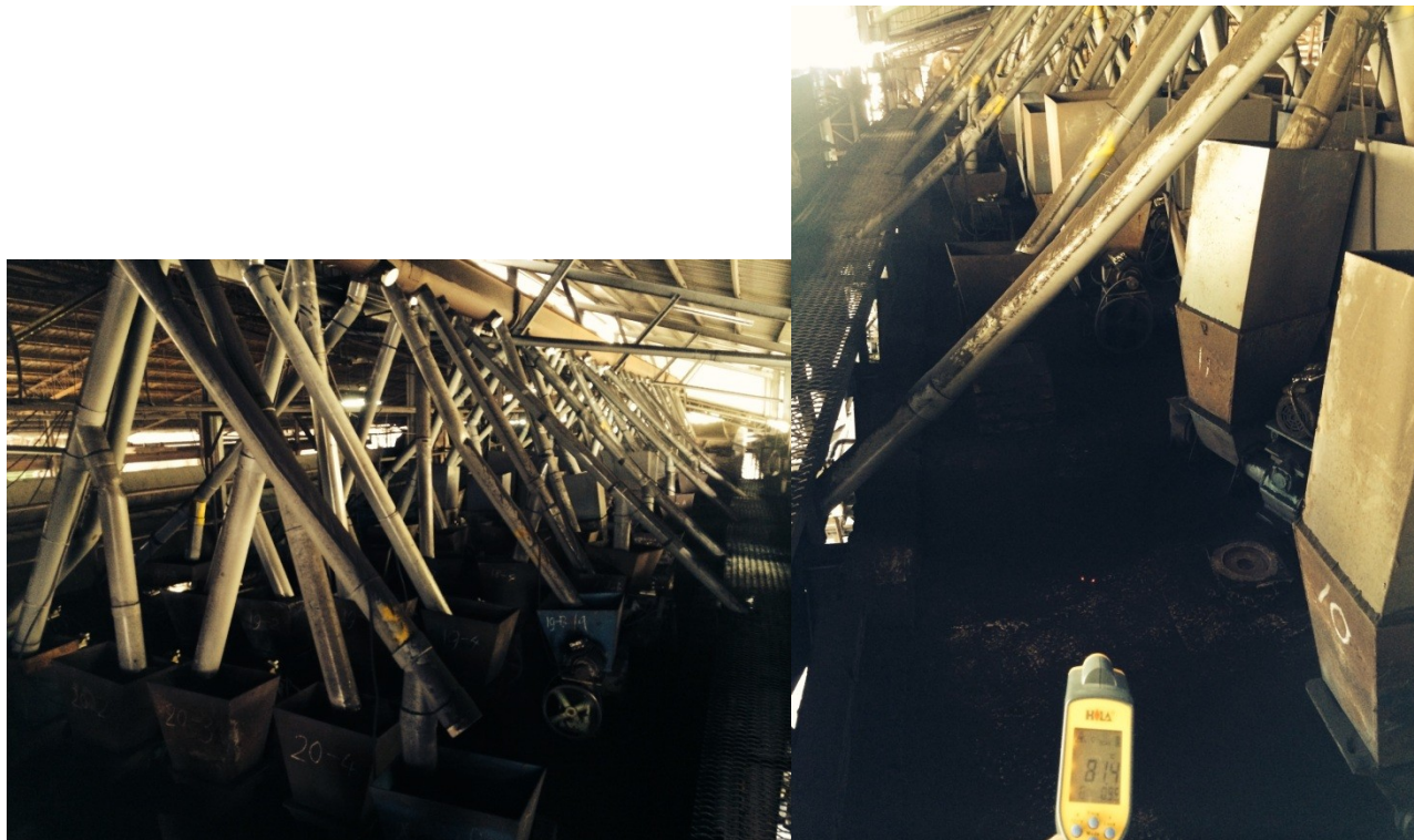
▲ 現場高溫燒結實況，人站立區溫度顯示 81.4°C。
